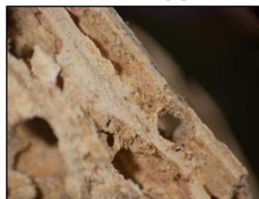
Orifices d'envol et vermoulure
